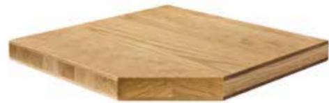
**Kompromisslose Ästhetik und hervorragende Stabilität:** Diese beiden Punkte werden in unserer innovativen 3-Schicht-Platte vereint. Sie besteht aus drei Massivholzlagen, welche kreuzweise aufeinander verleimt werden. Dabei werden die Schichten jeweils um 90 Grad gedreht. Eine hohe Festigkeit, Maßhaltigkeit und Formbeständigkeit sind das Ergebnis. Weil diese Technologie besonders verzugssicher ist, kommt die 3-Schicht-Platte bei unseren Küchenfronten zum Einsatz.
